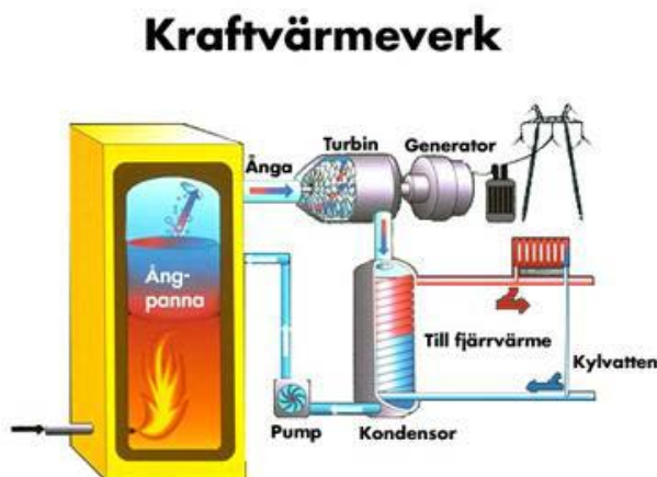
Figur 5.1 Principiell skiss av ett kraftvärmeverk
