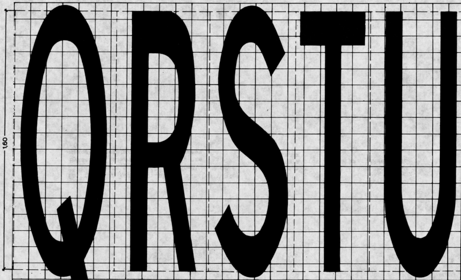
Letter markings for roads with a speed limit of 60 km/h or less. measures in meters Bokstavsmarkeringar på vägar med hastighetsbegränsning till 60 km/h eller lägre hastighet.
