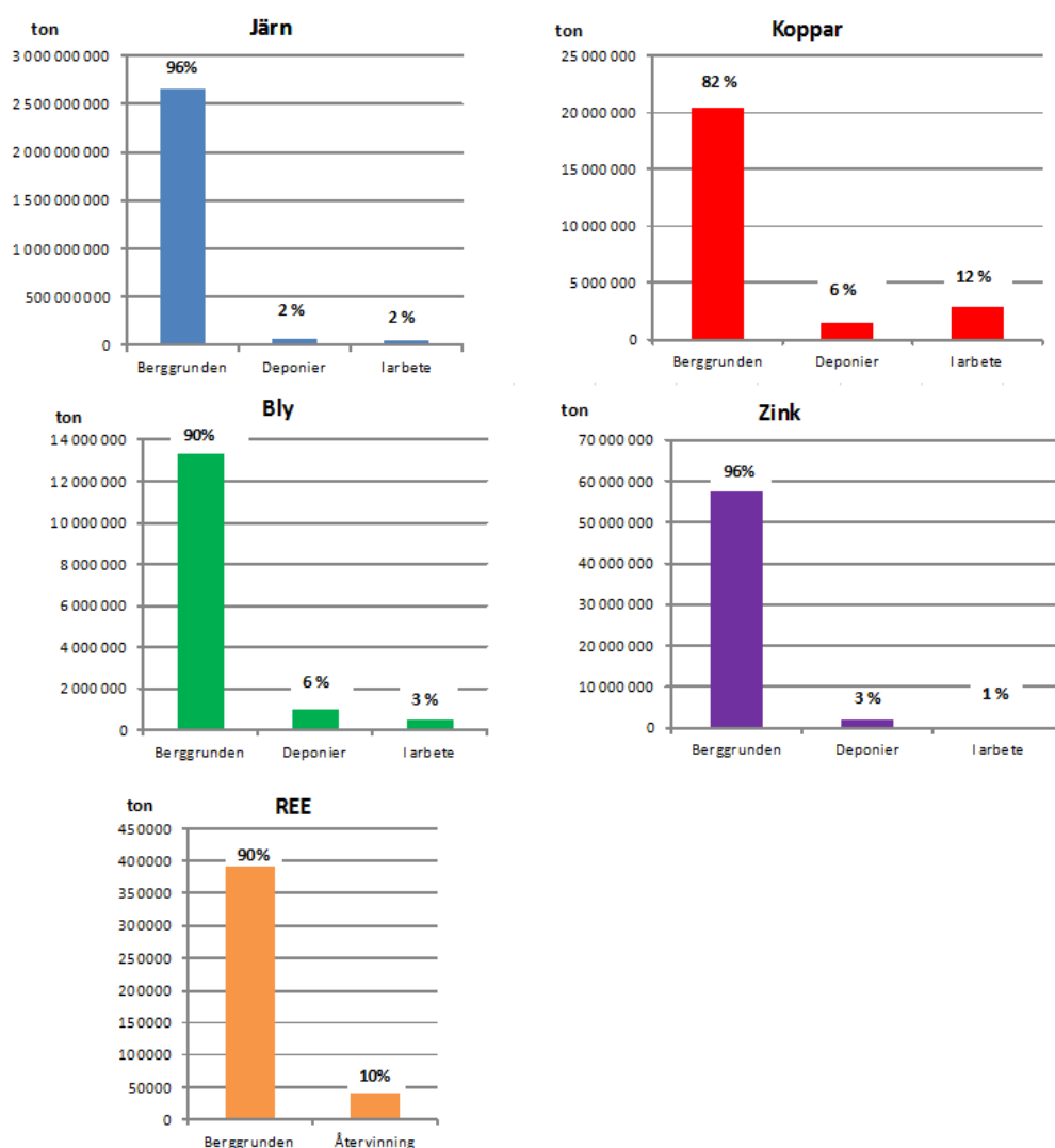
Figur 1. Sammanfattning av potentialer i berggrund, deponerat och i användning. Med "i arbete" avses metall och mineral som fortfarande är i bruk i samhället. Med deponier avses här alla deponier, oavsett om de är nedlagda eller ej. Källa: SGU (2014).
