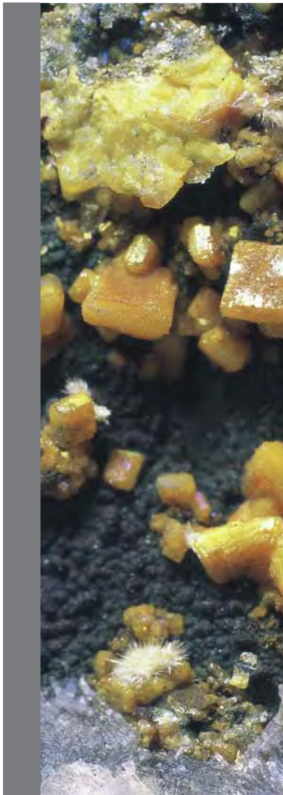
Bilden visar orangegula kristaller, upp till ca. 1,5 mm, av bly-antimon-oxykloridmineralet nadorit, ett karaktärsmineral för de komplexa och extremt mineraldiversifierade mangan-järnförekomsterna av Långbantyp i västra Bergslagen. Foto: Erik Jonsson/SGU.
