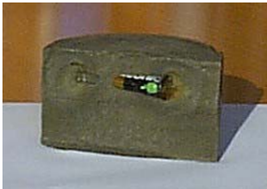
Figur 17 Uppskuret prov med alkalibatterier från vilket elektrolyter pressats ut vid kompakteringen (halobildningar)
