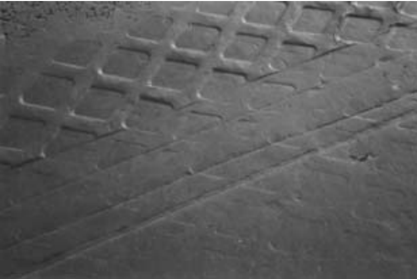
Figur 11 Homogen struktur hos kompakterad Friedland Ton
