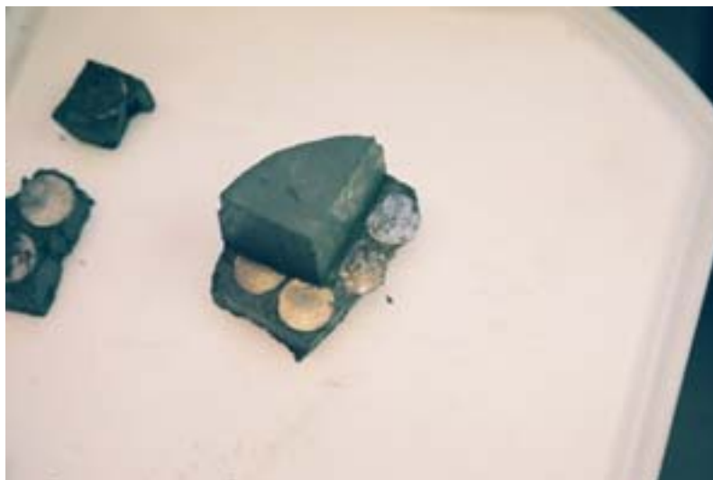
Figur 20 Uppskuret prov med batterierna i okulärt sett opåverkad form
