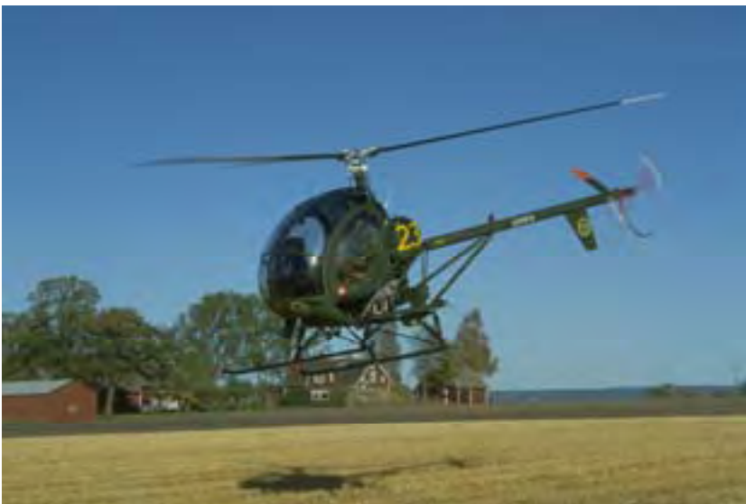
Lätt helikopter med kolvmotor, HKP 5, Hughes 269/300.
