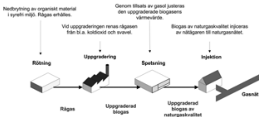
Figur 9.2 Uppgradering av biogas för injektion till naturgasnätet
