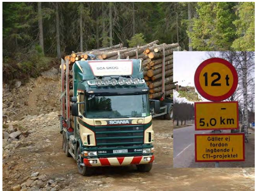
Figur 3 Virkesfordon utrustat med CTI – Central Tire Inflation, vid Skogforsks implementeringsstudie av tekniken
