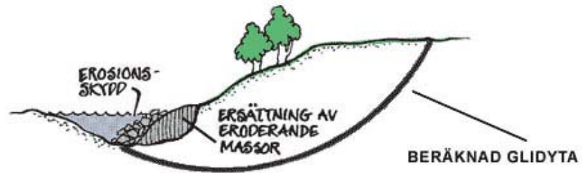
Figur 6.5 Återställning av slänt och utläggning av erosionsskydd. (Skredkommissionen Rapport 5:95)
