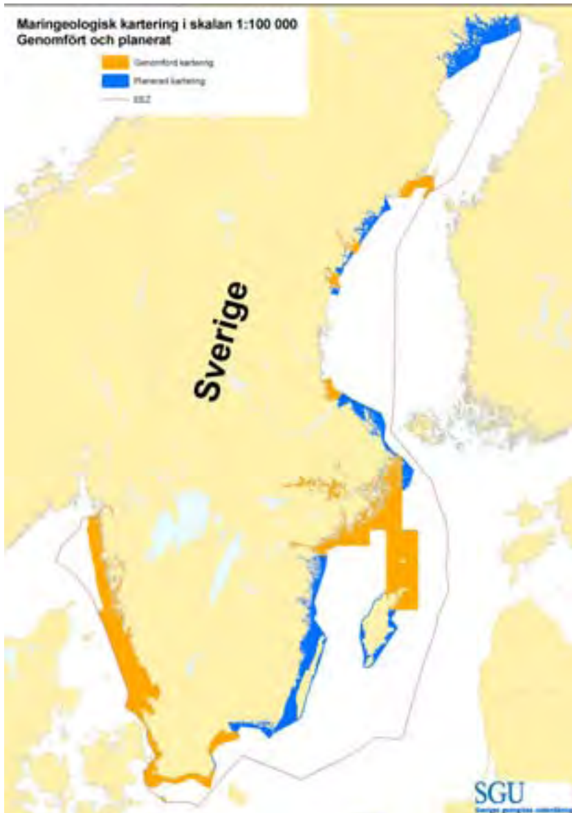
Figur 5.2 Karta med havsområden som kartlagts maringeologiskt till och med 2007 respektive kommer att kartläggas fram till 2012 i skala 1:100 000. Röd linje markerar yttre gräns för Sveriges ekonomiska zon.
