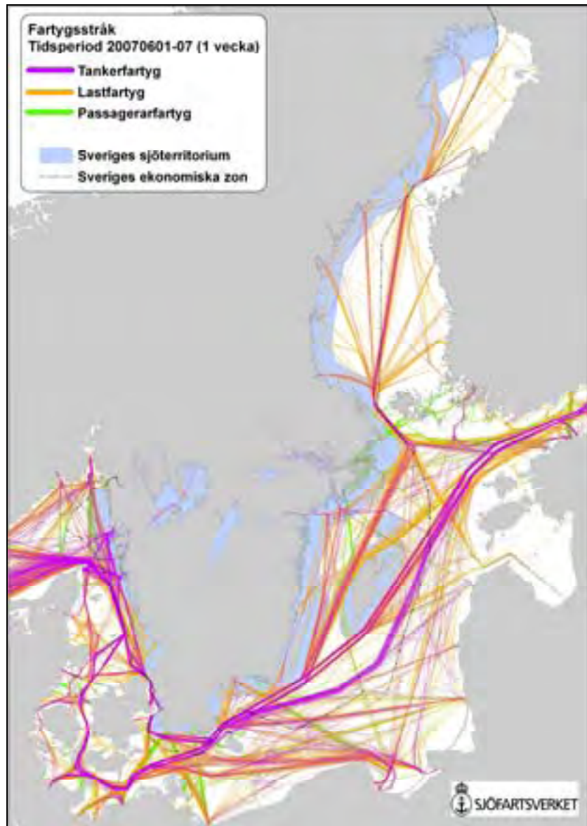
Figur 4.4 Kartan visar fartygstrafik i svenska och angränsande farvatten. Kartan bygger på data från Sjöfartsverkets rapporteringssystem för AIS-information (Automatic Identification System). Detta är ett säkerhetssystem för fartyg som bygger på att fartyg kontinuerligt sänder ut information om bl.a. position, kurs och fart.
