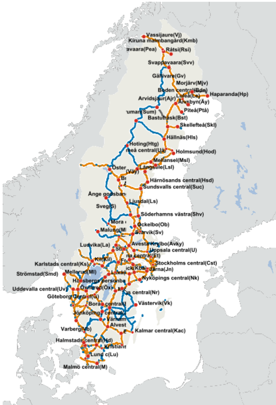
Figur 25 Banor med kontaktledning (orange) och banor utan kontaktledning (blå) (NJDB). 138
