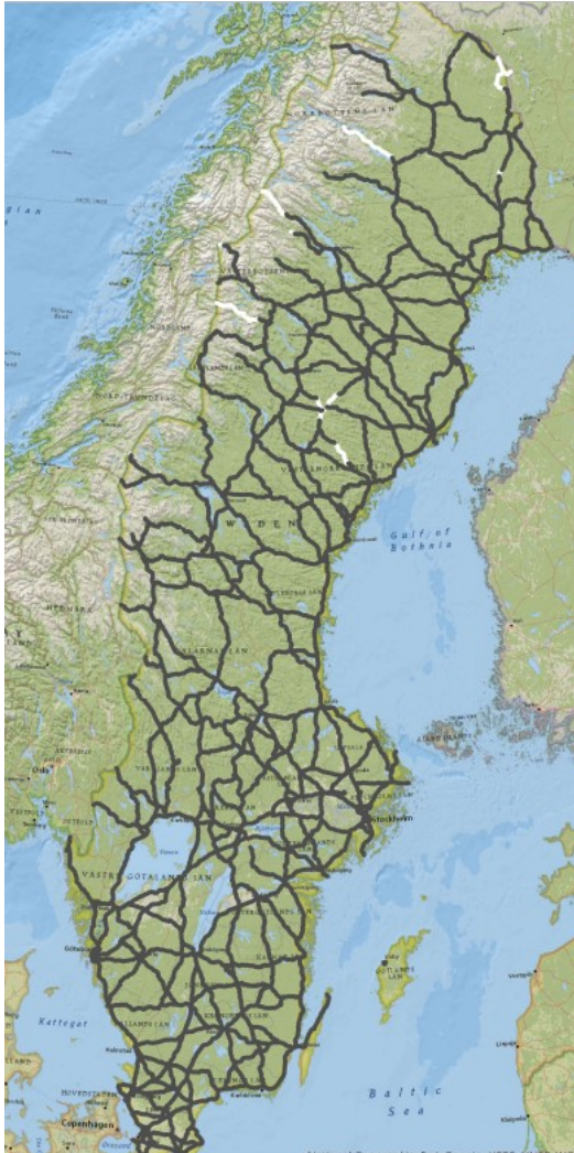
Figur 22 Karta över snabbladdningsinfrastrukturen längs större vägar i Sverige från våren 2024. Kartan visar de vita sträckor där det saknas snabbladdning på 150kW längs större statliga vägar med ett maxavstånd på 10 mil mellan varje laddningsstation förutom TEN-T vägnätet där det är 6 mils avstånd. I kartan antas laddstationer som beviljats stöd inom ramen för Klimatklivet eller av Energimyndigheten respektive Trafikverket som befintliga.
