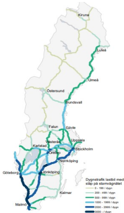
Figur 12. Kartan visar flödet av lastbilar med släp (>3,5 ton). I det ingår dragbil och semitrailer (inklusive "EU-långtradare" lastbil med påhängsvagn (≤16,5 m). Trafikflödena baseras på Trafikverkets trafikmätningar, där olika vägsträckor har mätts olika årtal. Kartan är hämtad från Trafikverket. 54
