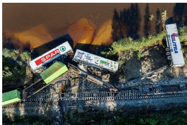
Bild 2 visar ett urspårat godståg, efter att skyfallet i Västernorrland i september 2025 fått banvallen att kollapsa. Foto: Mats Andersson / TT.
