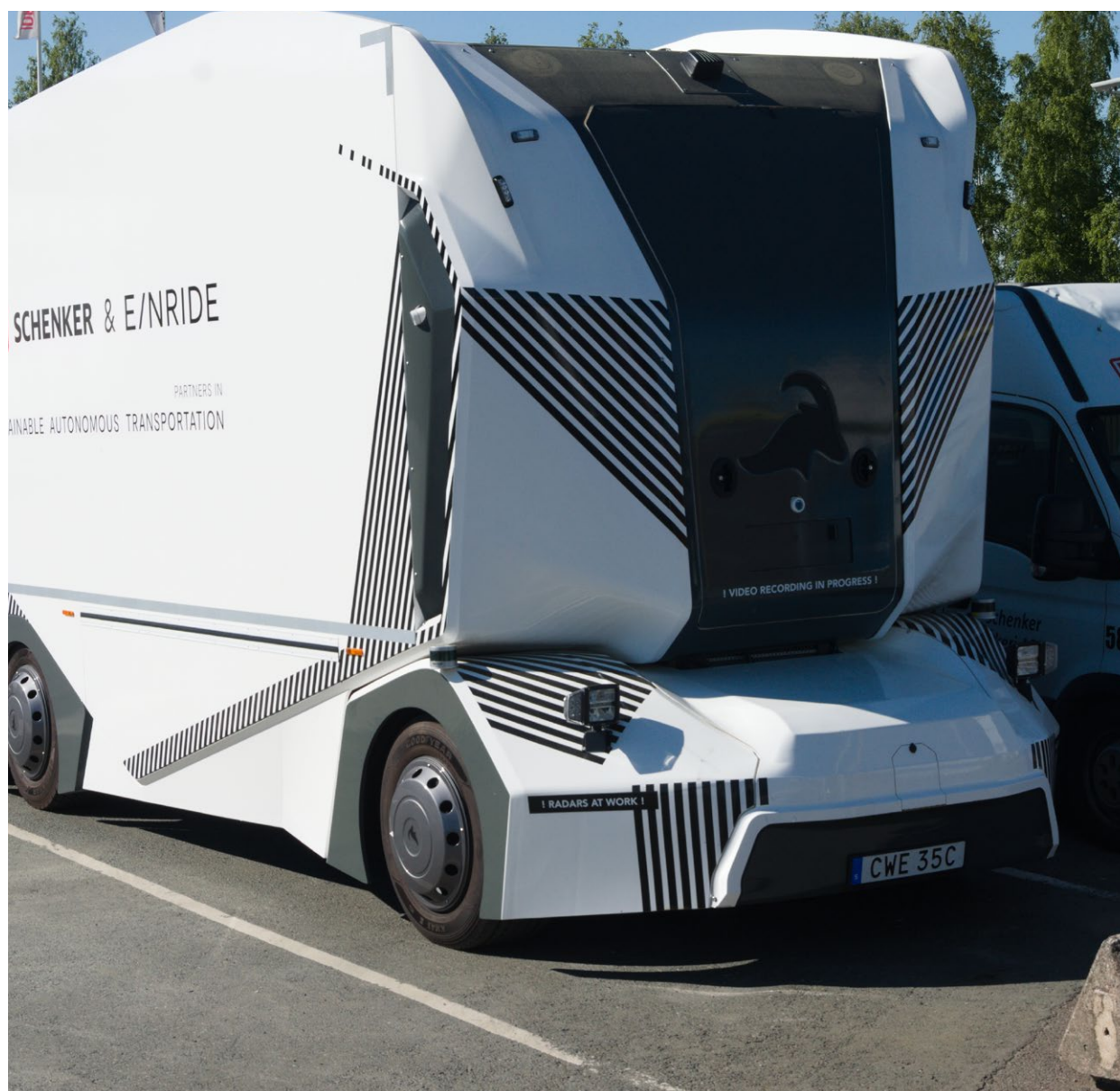
Einrides självkörande, eldrivna lastbil, T-pod på svenska vägar. Bilden tagen i Jönköping i maj 2019. Foto: Wiktor_swe/Shutterstock
