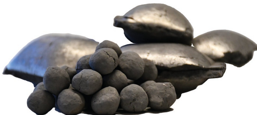
Tillverkning av järnsvamp genom direktreduktion med vätgas. Foto: Åsa Bäcklin. Källa: HYBRIT.
