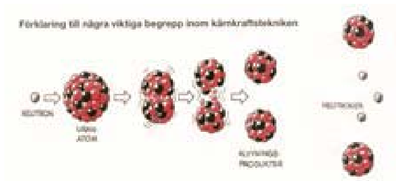
Figur 4.2 Schematisk beskrivning av klyvningsprocessen (fission). En neutron infångas av en uranatom, som exciteras och klyvs (fissionerar) i två delar (klyvningsprodukter). Samtidigt avges ett antal neutroner.
